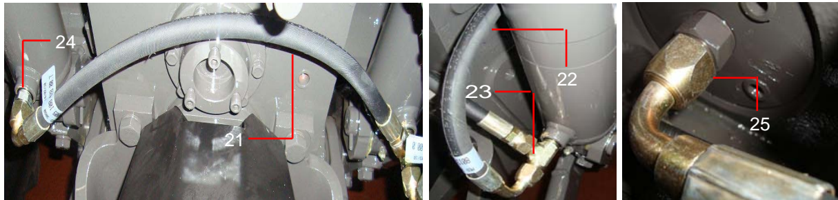
Novo Sistema da tubulação hidráulica do cilindro auxiliar
